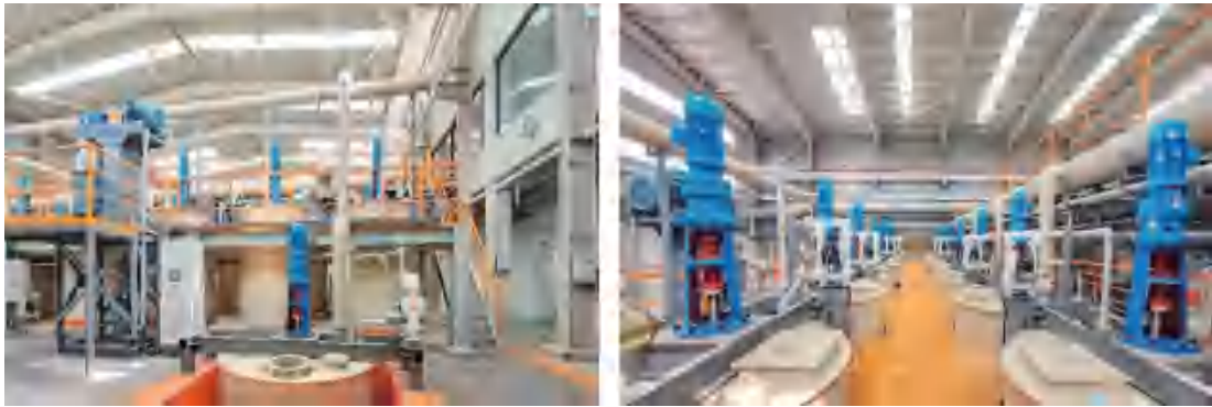
图3 抛光粉化学制备系统
