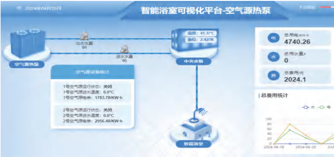
图22 空气源热泵系统智控图
