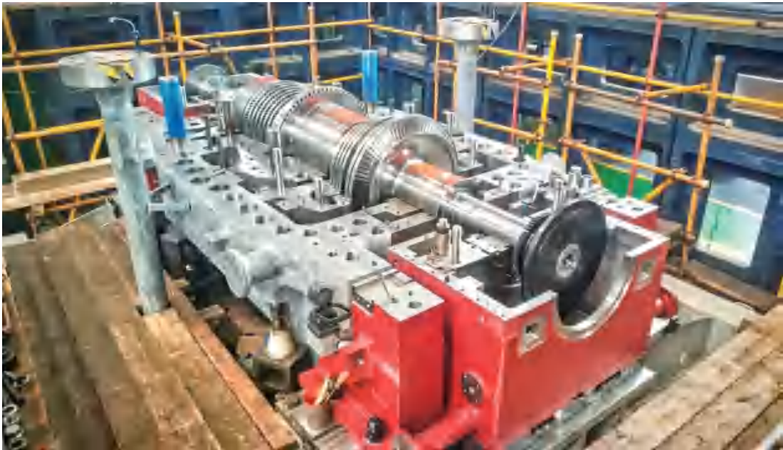
图5 某汽机厂生产的背压式汽轮机转子结构
